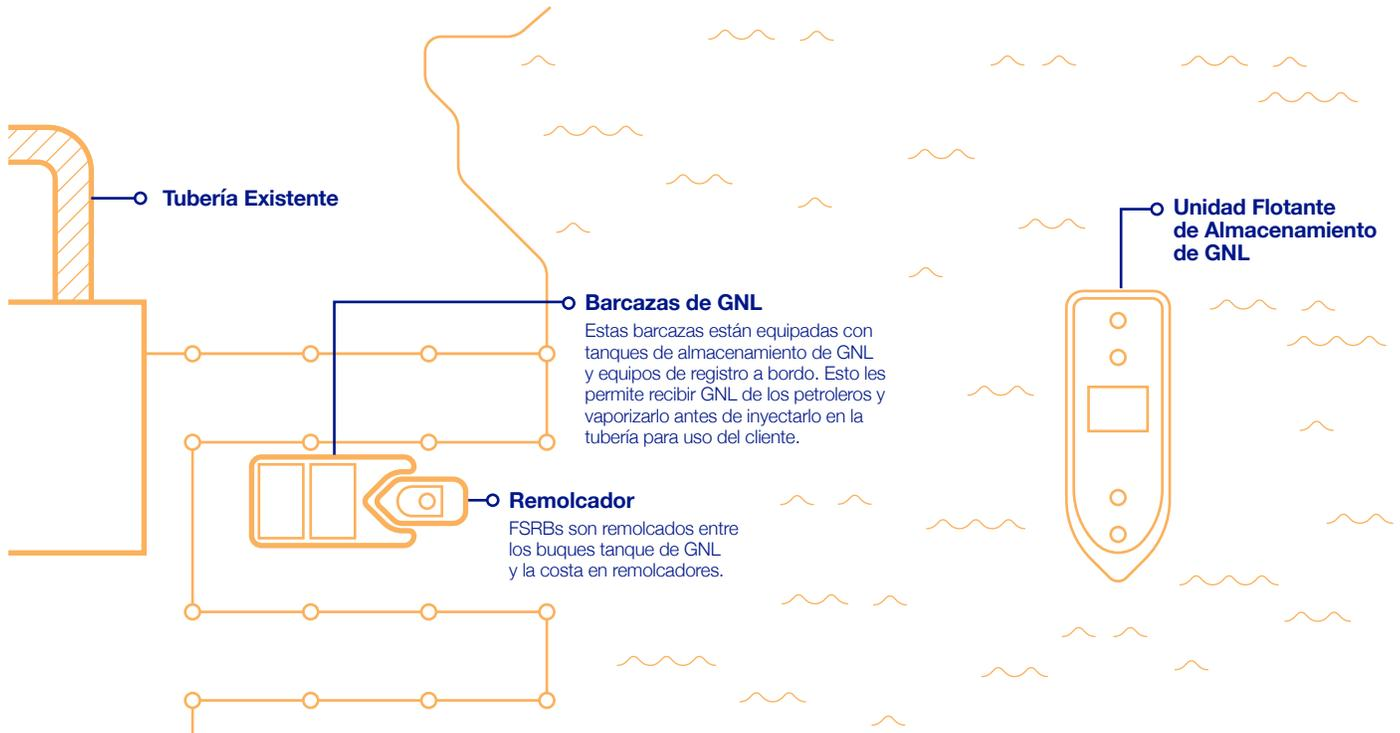
**DESCRIPCIÓN** Con esta opción, se construirían una o más Barcazas de GNL especializadas con equipos de vaporización a bordo. Llamadas Barcazas Flotantes de Almacenamiento y Regasificación (BFAR), estas embarcaciones serían remolcadas a lugares donde el acceso al agua, la capacidad del muelle y el sistema de gas para llevar les permite transferir GNL desde una variedad de fuentes terrestres y marítimas e inyectar gas natural vaporizado en la tubería existente en tierra.
